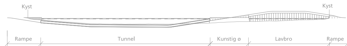
Løsningsmodel 7 : Boret tunnel for jernbane og bro for vej
