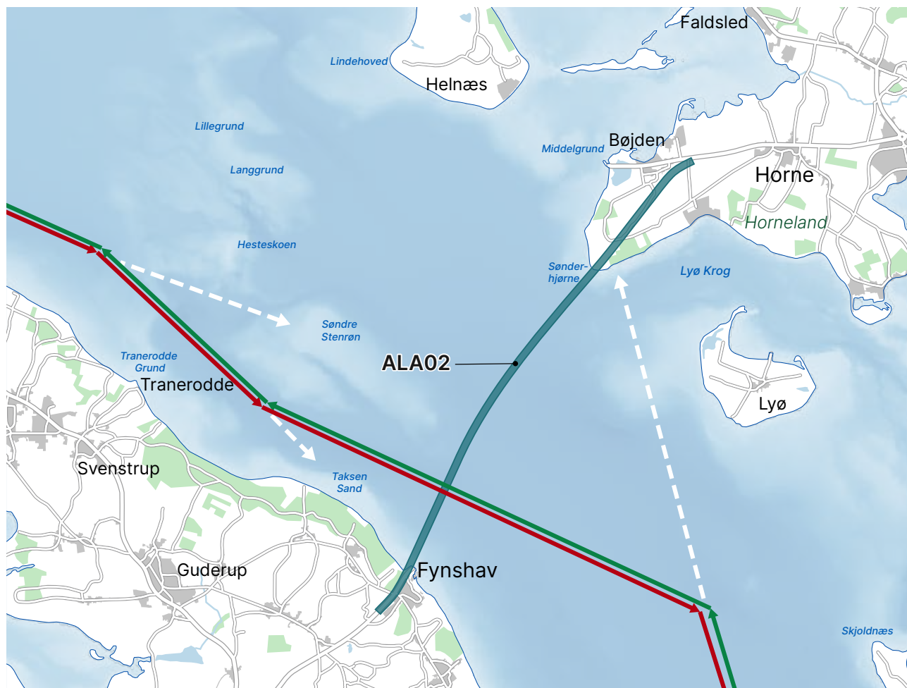
Figur 3.14 Anbefalede sejlruiter, som markeres med bøjer for hhv. sydgående (rød) og nordgående (grøn) trafik. Hvidstiplet er en illustration af at trafikken ikke vil lede til påsejling af broen i tilfælde af at skibene ikke ændrer rute ved ruteknæk, fordi de enten vil støde på grund ved Sødre Stenrøn, Taksensand eller Horneland.
