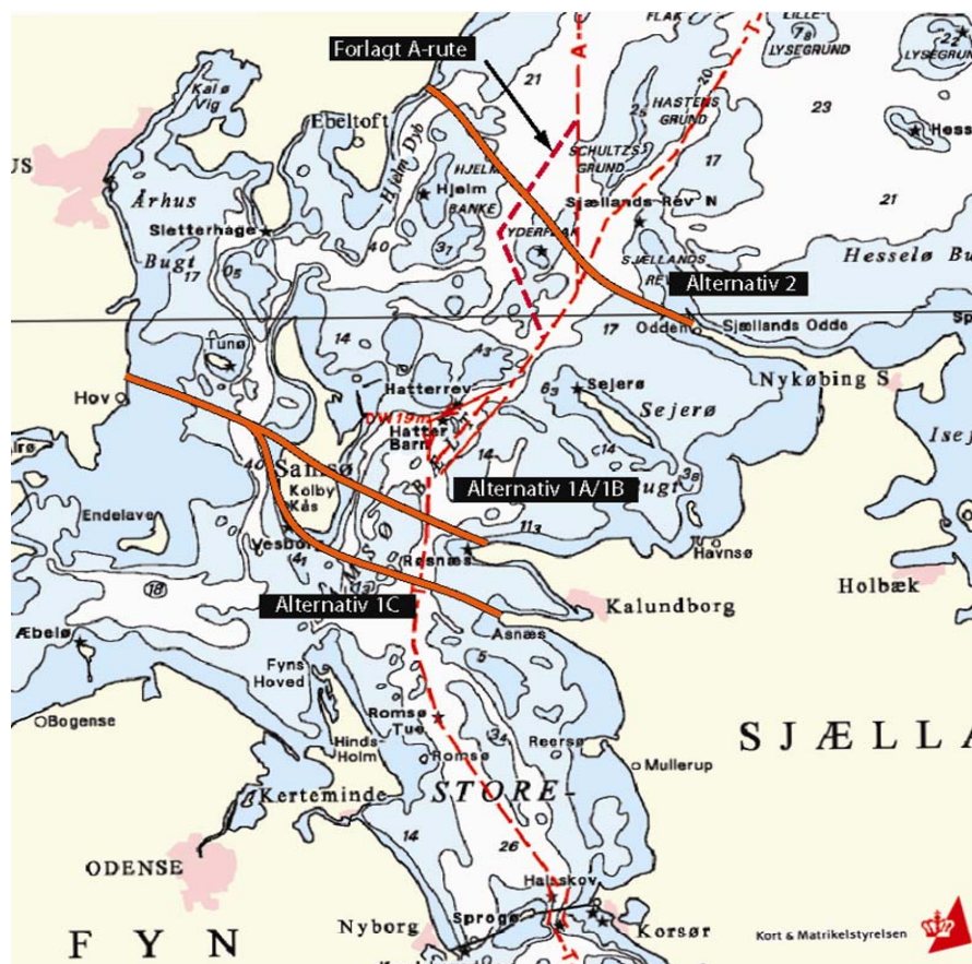
Figur 5: Skematisk angivelse af de tre broforbindelser i alternativ 1A, alternativ 1C og alternativ 2.
