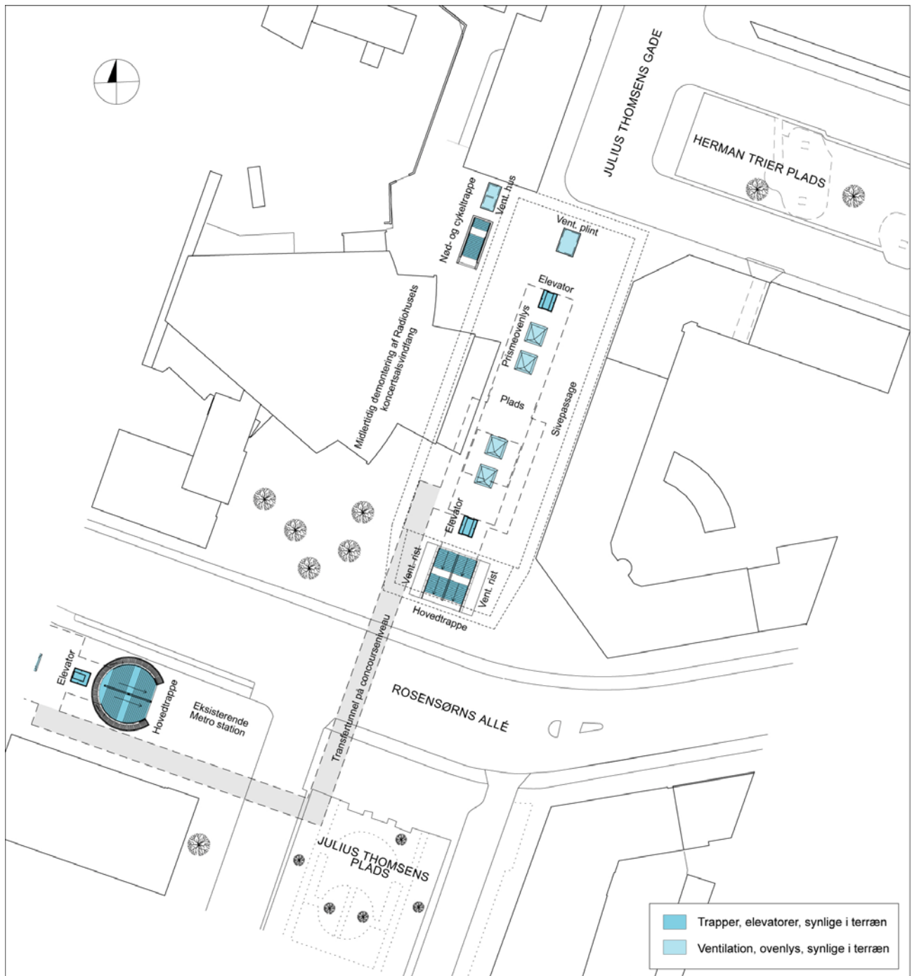
Figur 7.35 Forslag til placering af Cityringens perron ved Forum. Cityringens del af stationen er vist som en dyb typestation med ovenlys, elevatorer og trapper. Den dybtliggende perronforbindelse er ikke vist, men den supplerende forbindelsestunnel mellem de to stationers concourse-niveauer er vist gråtonet. Der etableres også elevator nr. 2 til den eksisterende Metroperron (uden for tegningen). Tegningen findes i tegningsbindet under sektion 8 i målestoksforholdet 1:500.
