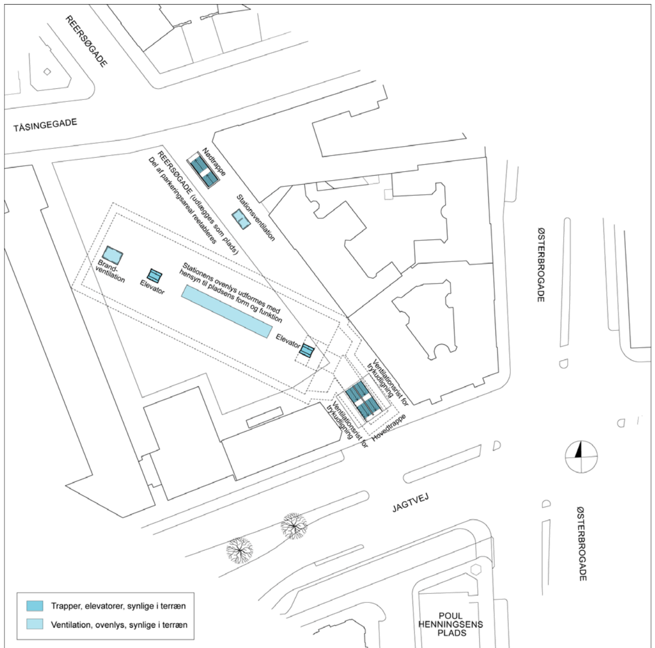
Figur 7.24 Forslag til stationsplacering i Reersøgade. Tegningen findes i tegningsbindet under sektion 6 i målestoksforholdet 1:500.
