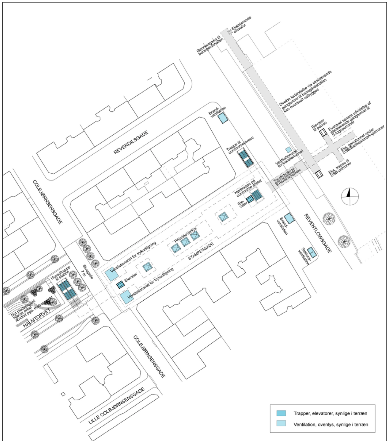
Figur 7.4 Forslag til placering af Cityringens perron. Anlægget sker ved København H som en forlænget tpestation med ovenlys, elevatorer og to trapper. Fra concourseniveau etableres tunnelforbindelse til den eksisterende perrontunnel under København H. Tegningen findes i tegningsbindet under sektion 6 i målestoksforholdet 1:500.
