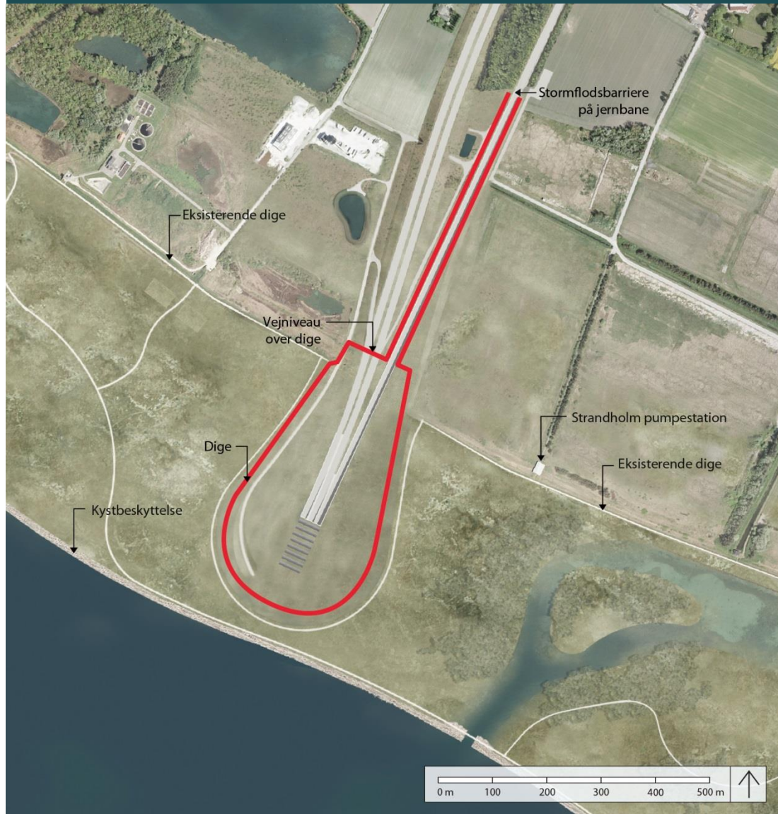
FIGUR 2.27 Portal- og rampeområdets hovedelementer på Lolland
