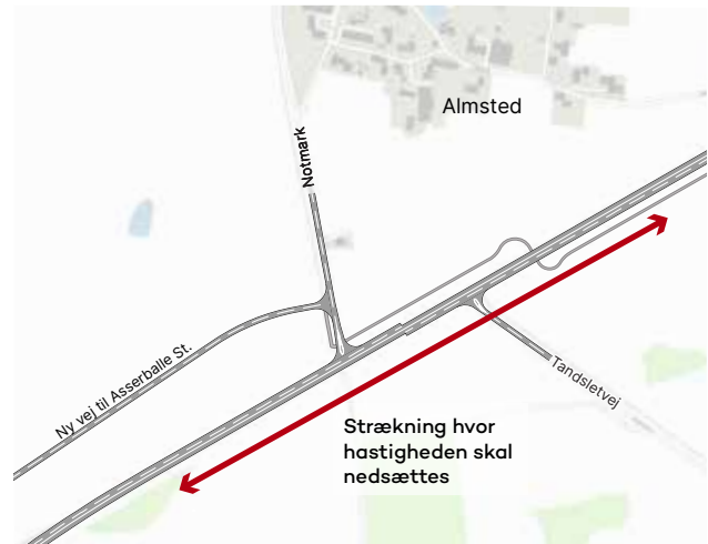
Figur 4.7 Ved Almsted nedsættes hastigheden over en strækning på ca. 650 meter ved krydset med forskudte sideveje.
