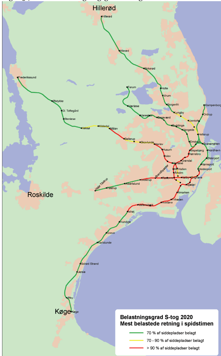
Figur 5.7 Forventet belægningsgrad i S-tog
